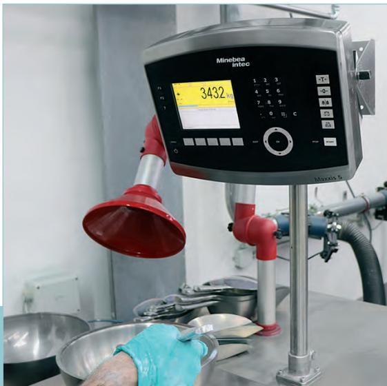
使用台秤精确称量颜料和添加剂。抽气系统可确保应用始终无尘。
