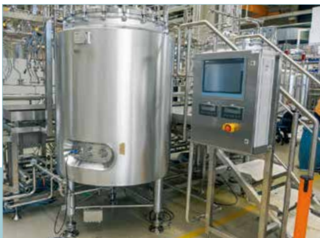
Novego称重模块带有内置高度调节器，安装特别方便。
