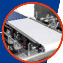
无需使用工具即可快速拆卸称重和传输皮带
